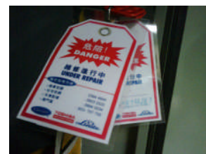
不正確的警告牌
